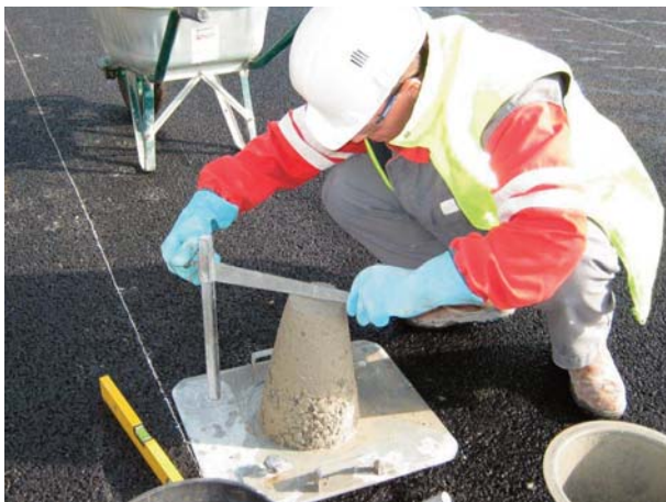
Mesure d'affaissement au cône d'Abrams
