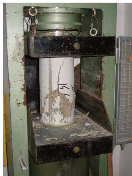
Ecrasement d'une éprouvette par compression
